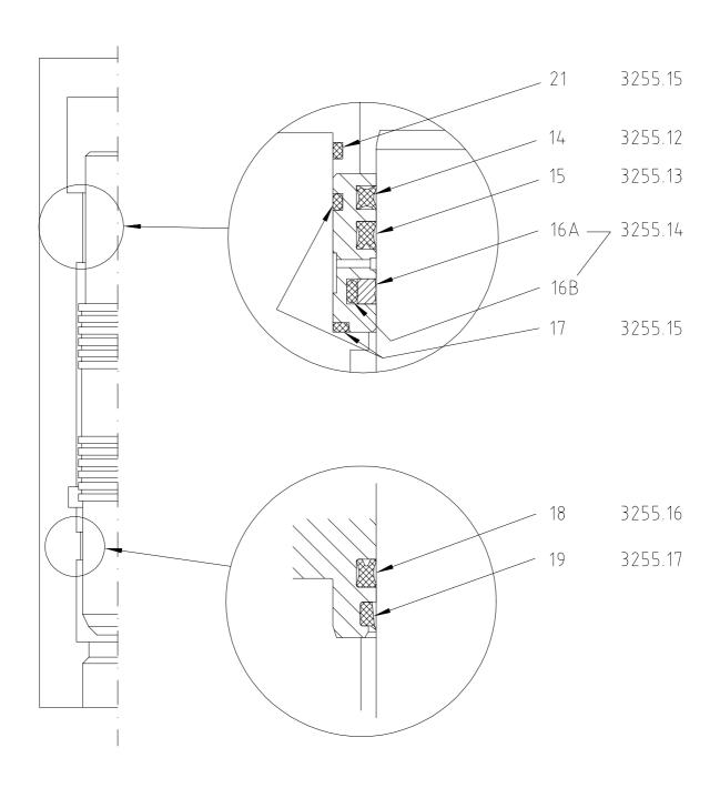
Montageanleitung der Schlagkolbendichtungen
